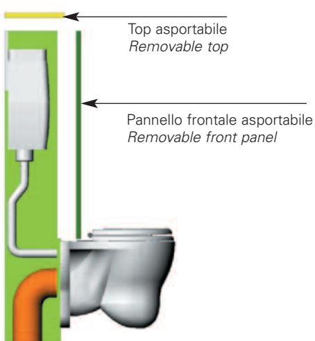
È sufficiente sollevare il top ed asportare il pannello frontale della parete per ottenere l'accesso a tutti gli impianti di adduzione e di scarico.
